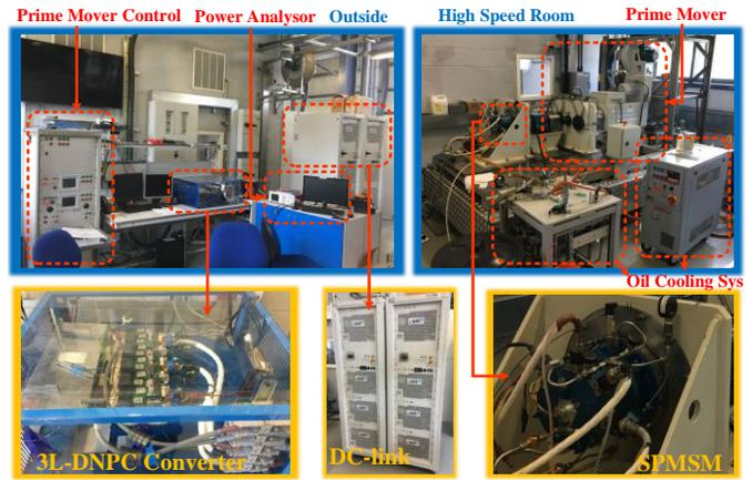
Fig. 23. ESG test rig setup
