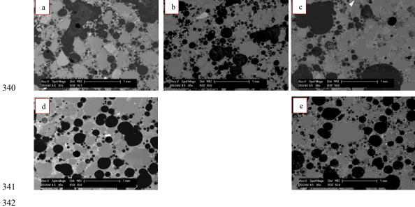
Fig. 5. SEM images for the selected 1600 kg/m<sup>3</sup> mixes (a) FC6 (b) FCs6 (c) FCf6 (d) FCp6 and (e) FCa6
