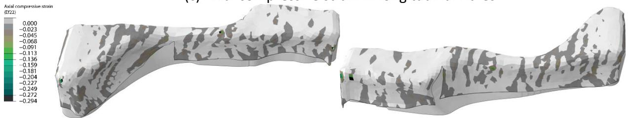
(d) Axial compressive strain in transverse fibres
