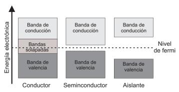
Fig. 1. Banda de energía de los materiales conductores, semiconductores y aislante.
