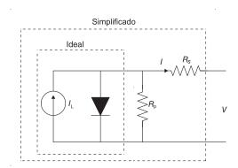
Fig. 3. Circuito equivalente de un panel solar.
