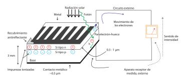
Fig. 2. Célula solar fotovoltaica conectada a un circuito eléctrico externo.
