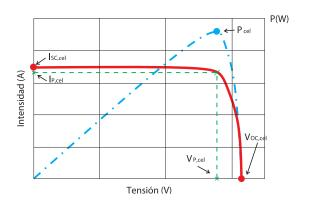
Fig. 4. Curva característica I-V de una célula solar fotovoltaica.
