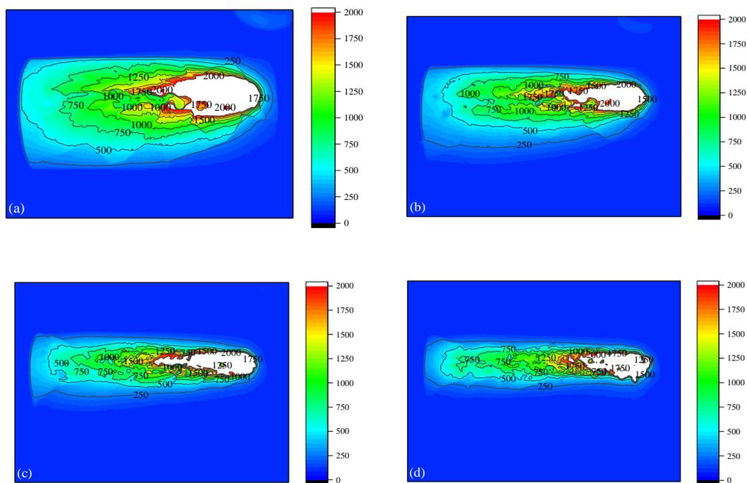
Fig. 7. Rock temperature versus moving speed (a) 0.5mm/s (b) 1mm/s (c) 2mm/s (d) 4mm/s
