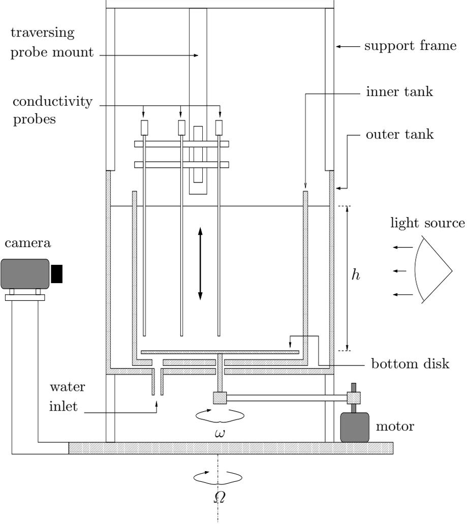
Fig. 1. Experimental apparatus.
