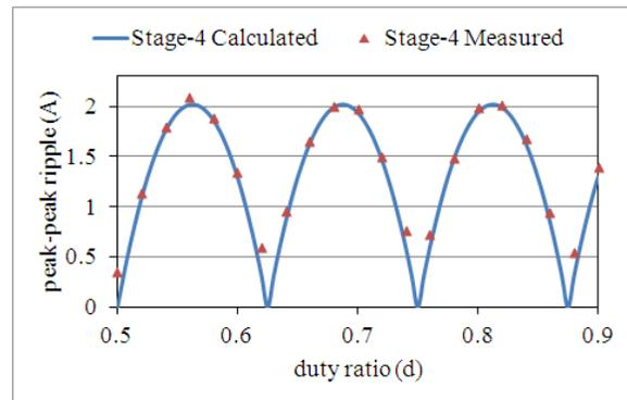
(d) Peak-to-peak ripple in stage-4 channel current
